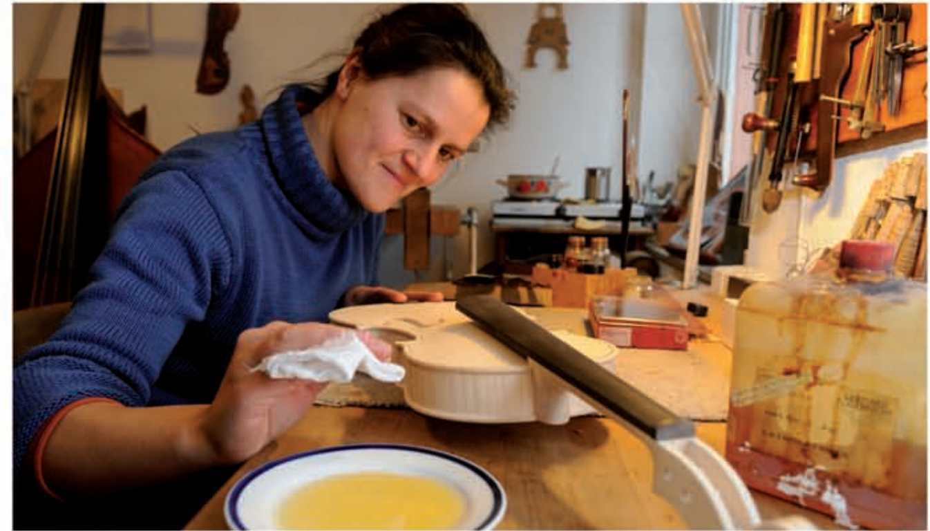
Noch bevor die Geige lackiert wird, behandelt Uta Böhm sie mit einem speziellen Öl.
